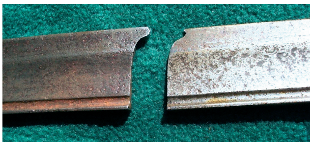
Rys. 2. Fragment głowni w miejscu złamania
