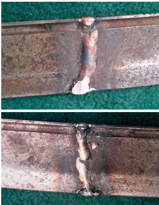
Rys. 3. Lico spoiny na obydwu stronach złącza doczołowego główki w miejscu złamania
